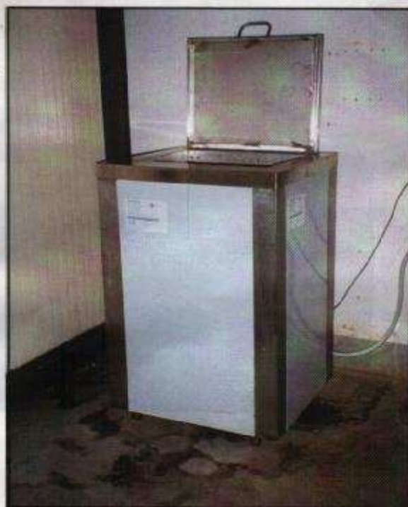
Macchina di lavaggio stampi per gomma (articoli tecnici) della Ultrasuoni I.E., dotata di ultrasuoni, doppia termoregolazione digitale, aspirazione automatica, serpentine di condensazione e distillazione a circuito chiuso del detergente
