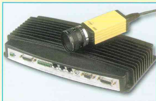
Telecamera digitale: per Il riconoscimento automatico pezzi
